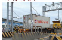
貨櫃進站經固定式RFID讀取電子封條並自動辨識
